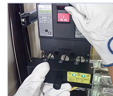
開閉器の負荷側の端子に取り付けて使用します。
