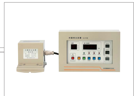
地震計 (工場・公共施設用) 地震が発生した際、揺れの大きさを検出・記録します。設定値を超える揺れを検出した場合は制御信号を発し、保安装置を作動させる役割も果たします。
