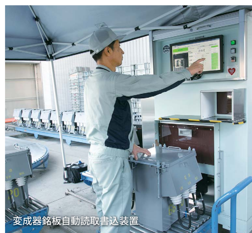
計器銘板自動読取書込装置(変付計器)
