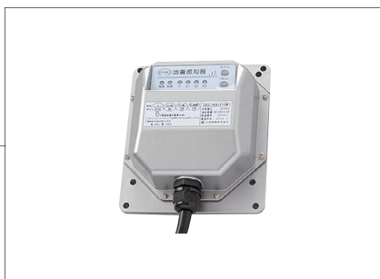
地震感知器 (エレベーター用) 大きな揺れを感知したとき、エレベーターを素早く最寄りの階に停止させるための制御信号を発します。
